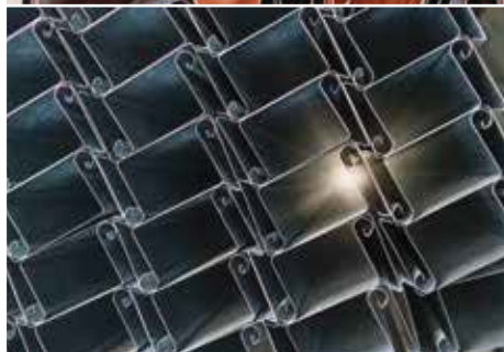
In der hauseigenen Abteilung Rinne & Rohr entstehen hochpräzise Bauteile für Dach und Wand: gefalzt, geschweißt, halbrund oder Kastenform, in Kupfer, Zink, Uginox, Ugitop, Alu oder Stahl verzinkt sowie in oberflächenbehandelten Ausführungen.
